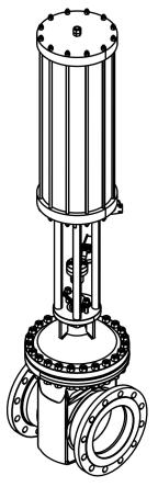
Fig. 14: Pneumatic actuator
